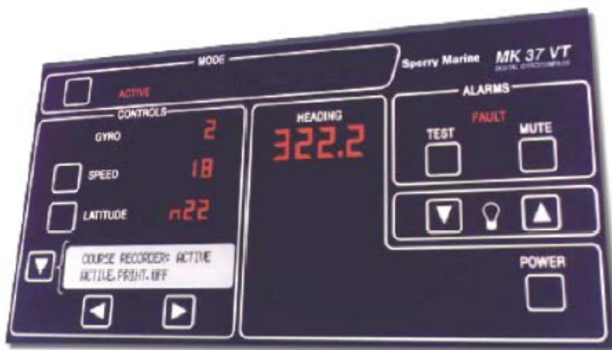
Rys.1 Panel kontrolno-sterujący żyrokompasu MK 37 VT Sperry Marine
