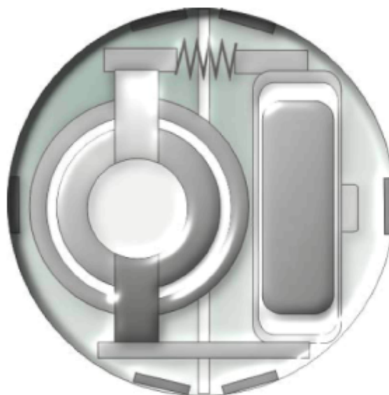
Rys.4. Przekrój poprzeczny kuli żyroskopowej
