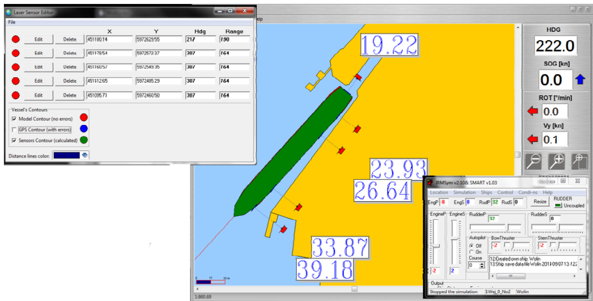
Rys. 5. Ekran monitora komputerowego w czasie symulacji z pozycjonowaniem za pomocą pomiarów laserowych (wzorcowa wodnica oznaczona kolorem czerwonym).
