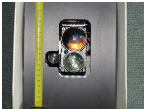
Rys. 1. Front głowicy dalmierzy. Położenie lunetek względem soczewek lasera Jenoptic Riegl (głowice 04 i 05).
