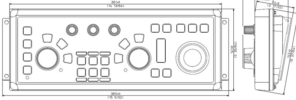
Weight : 1.8kg(4lb) [inclusive of base and connecting cable] ( 重量 ) ( 架台及び接続ケーブル含む )
